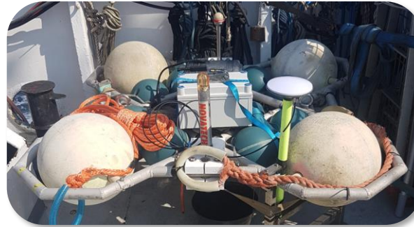
Bouée Trèfle équipée d'une antenne GNSS low-cost
