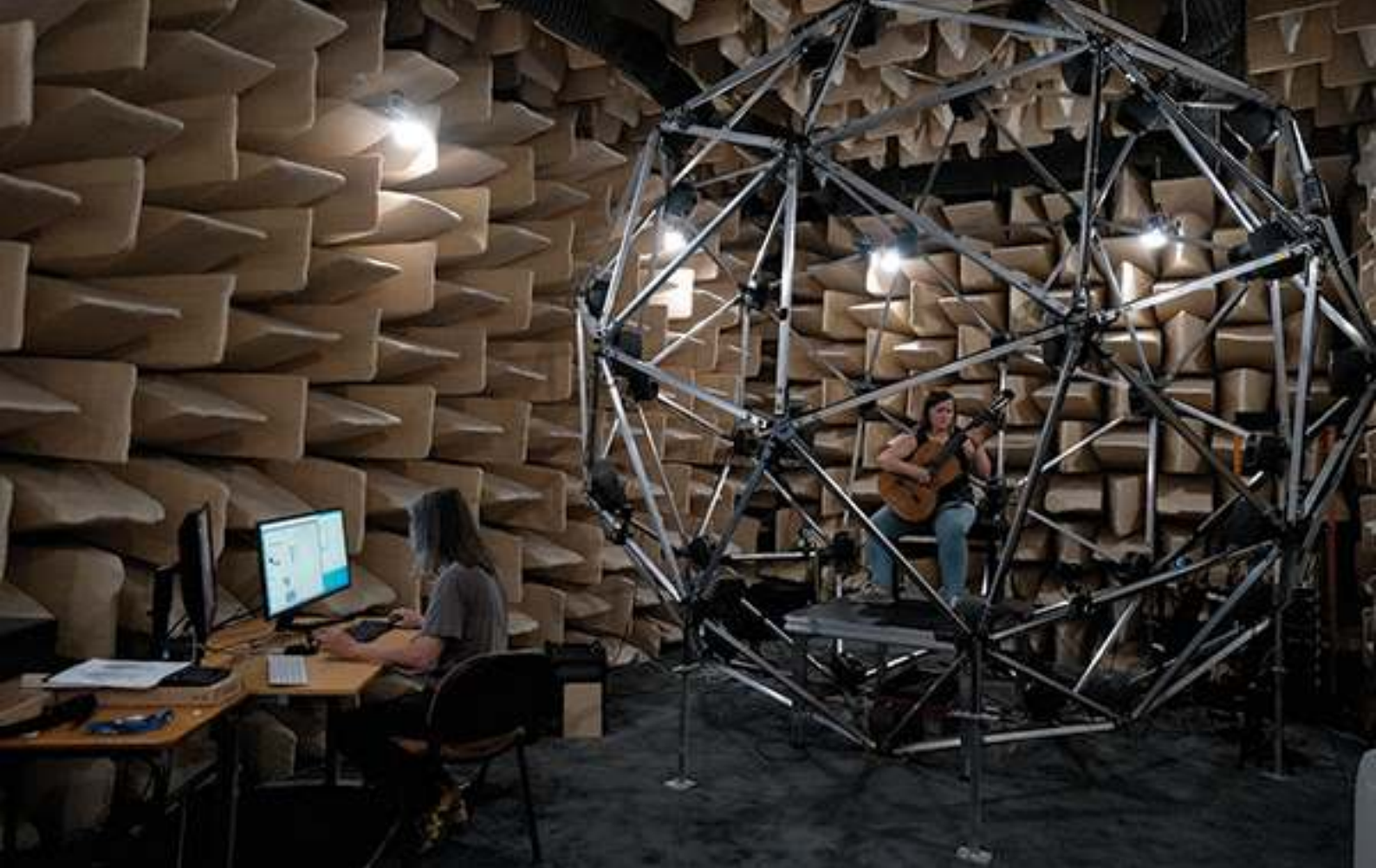
CAVE audio du laboratoire PRISM permettant de restituer virtuellement différentes acoustiques et d'étudier le jeu du musicien en fonction de ces acoustiques © Joran Tabeaud
