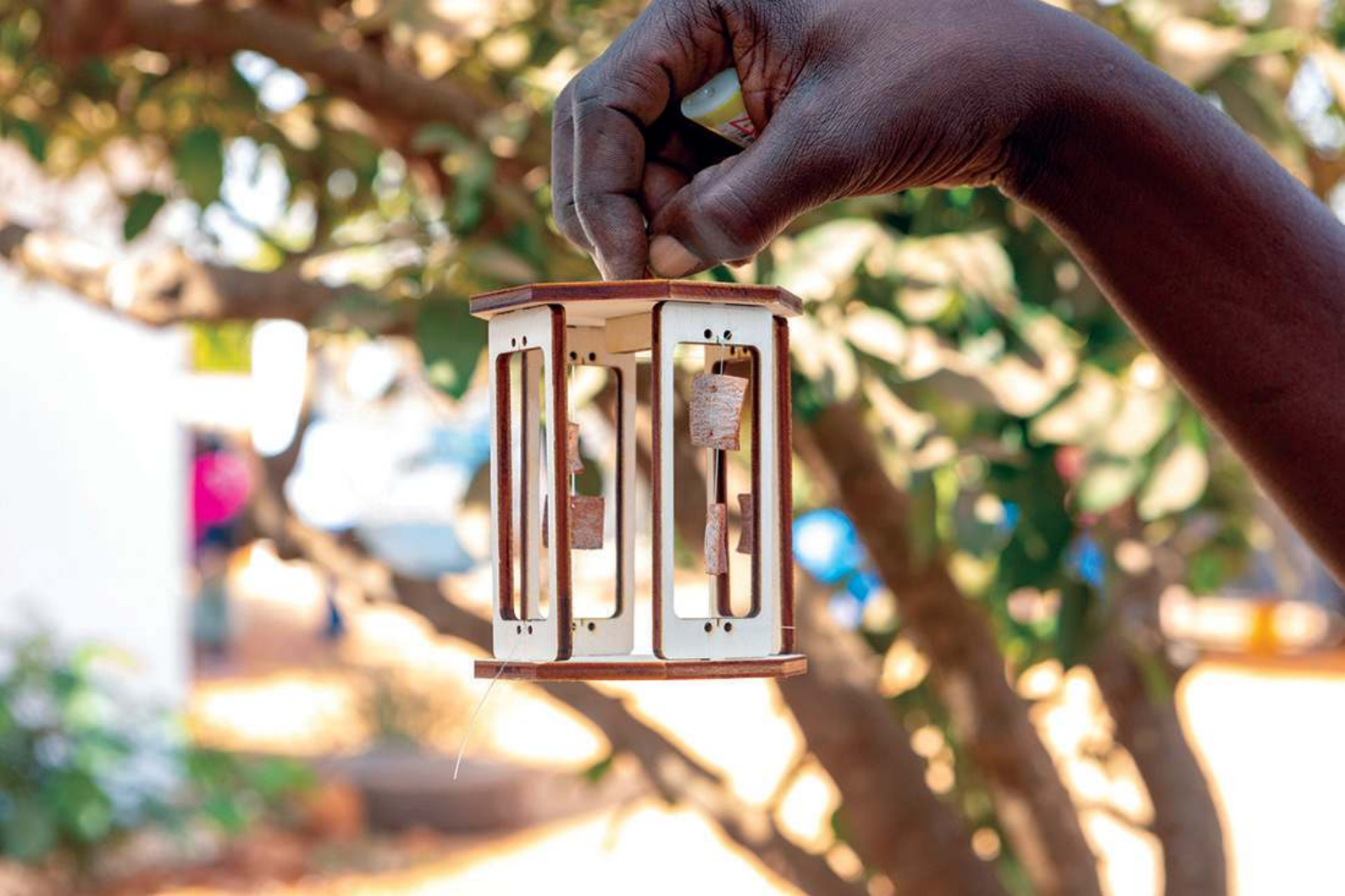
Capteur Airgeo de la qualité de l'air utilisant des écorces d'eucalyptus, Sebikotane, 2022 © Pape Mbathe Thiandoum
