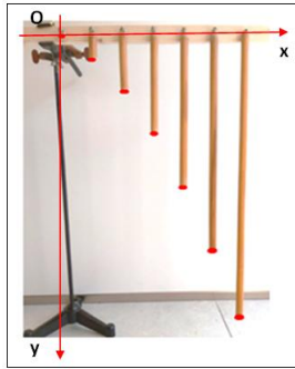
Figure 12. – Technique de jalonnement de la parabole décrite par un mobile lancé horizontalement
