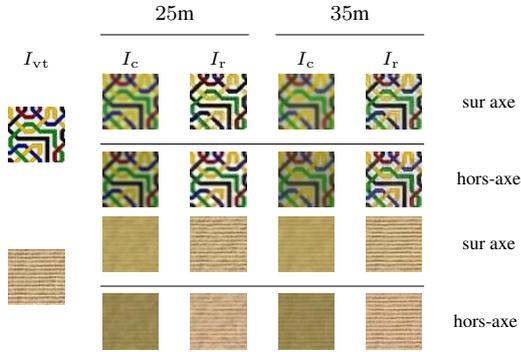
FIGURE 5 : Exemples de patches sur l'axe obtenus à deux distances avec les systèmes optimisés sur et hors de l'axe optique.  $I_{vt}$  est l'image de référence,  $I_c$  celle numérisée par le capteur et  $I_r$  le résultat du traitement.
