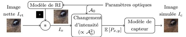
FIGURE 1 : Chaîne de génération d’image : l’image de vérité terrain  $I_{vt}$  est convoluée avec la RI pour obtenir l’image optique  $I_o$ , puis un changement de la dynamique en fonction du rayon de la pupille d’entrée  $\mathcal{A}_0$  est appliqué avant de simuler l’image bruitée et numérisée par le capteur  $I_c$ .
