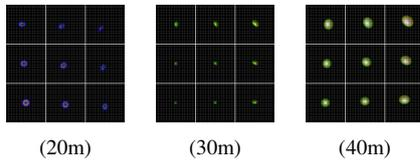
FIGURE 4 : RI du système obtenu avec un traitement constitué d'un réseau à 3 couches pour des angles de  $0^\circ$ ,  $5^\circ$  et  $10^\circ$ . Pour chaque RI le quadrillage fin indique les pixels du capteur.
