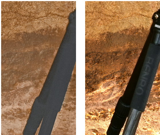
FIGURE 4 – Albédos estimés par PS « universelle » [17] et par PS calibrée. L'albédo est nettement mieux estimé avec la PS calibrée : l'inscription sur le trépied devient lisible.
