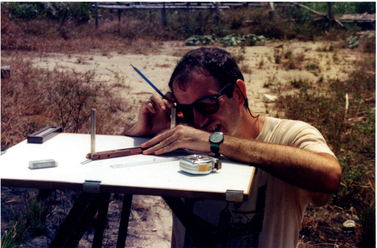
Fig. 2 – Relevé topographique du village Maillard à l'alidade nivelatrice, avec localisation des poteaux, des puits, des dépotoirs, des vestiges, des chemins, des arbres fruitiers, etc. (clichés S. Rostain).
