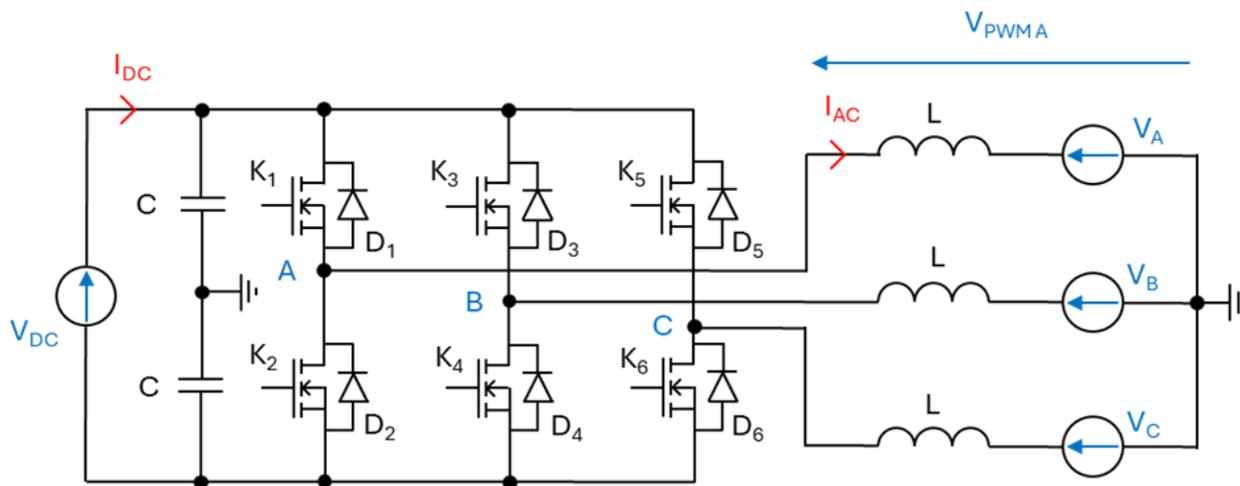
Figure 1 : Onduleur de tension triphasé avec filtrage
