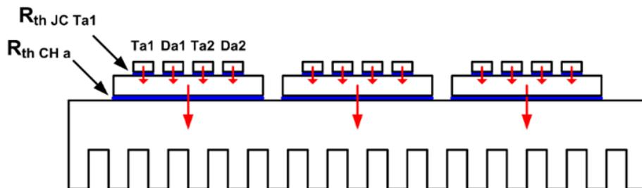
Figure 9 : Schéma thermique représentant 3 boîtiers sur un dissipateur
