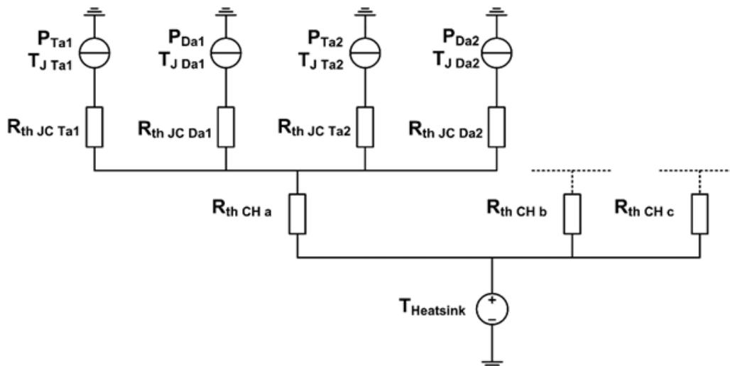
Figure 10 : Réseau de résistance équivalent au schéma thermique
