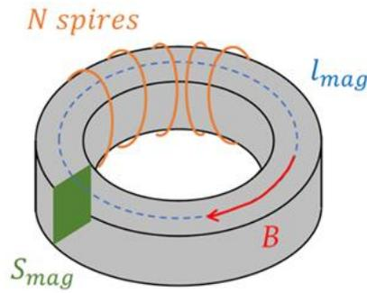
Figure 11 : Définition des paramètres de l'inductance torique
