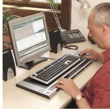
FIGURE 1. Barrette de cellules brailles électroniques. Les lettres s'affichent sous forme de caractères brailles (8 picots par lettre). Ici dans cette version professionnelle, il y a 80 cellules (VarioPro de Ceciaa). La personne aveugle ne peut lire que ligne après ligne.
