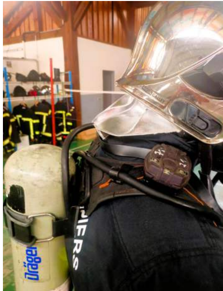
FIGURE 2. La balise homme-mort (localisée sur l'épaule) faisant partie de l'équipement d'intervention au feu des sapeurs-pompiers (crédit photo : auteurs 2023).
