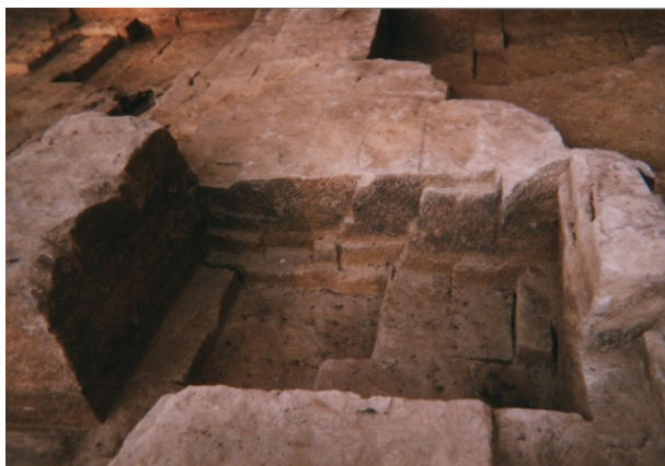
Fig. 31 – La carrière moderne : extraction en fosse de modules différents destinés à des encadrements de baies, piédroits, linteaux, de seuils ou appuis de baies. (Cliché Afan, 1998, Vacca-Goutoulli, 1999).
