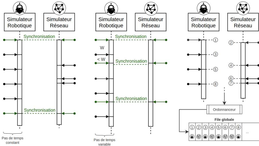
FIGURE 5.1. Méthodes de synchronisation de simulateurs de physique et de réseau. de gauche à droite : *time-stepped*, *variable time-stepped*, *global event-driven*
