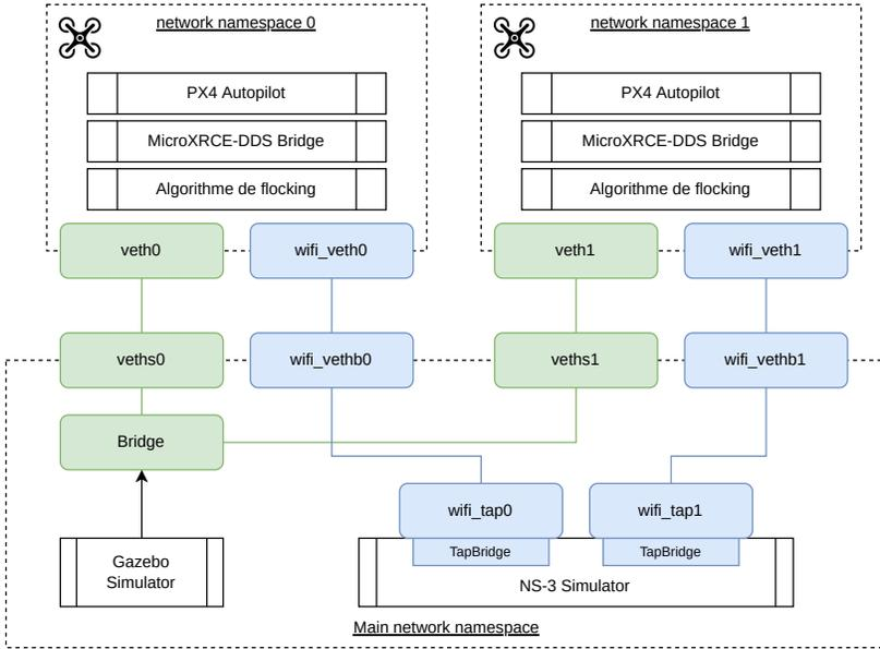
FIGURE 7.2. Architecture réseau de notre co-simulateur (2 drones)
