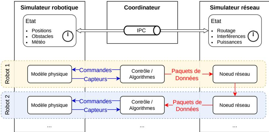
FIGURE 3.1. Architecture représentative d'un co-simulateur robotique et réseau
