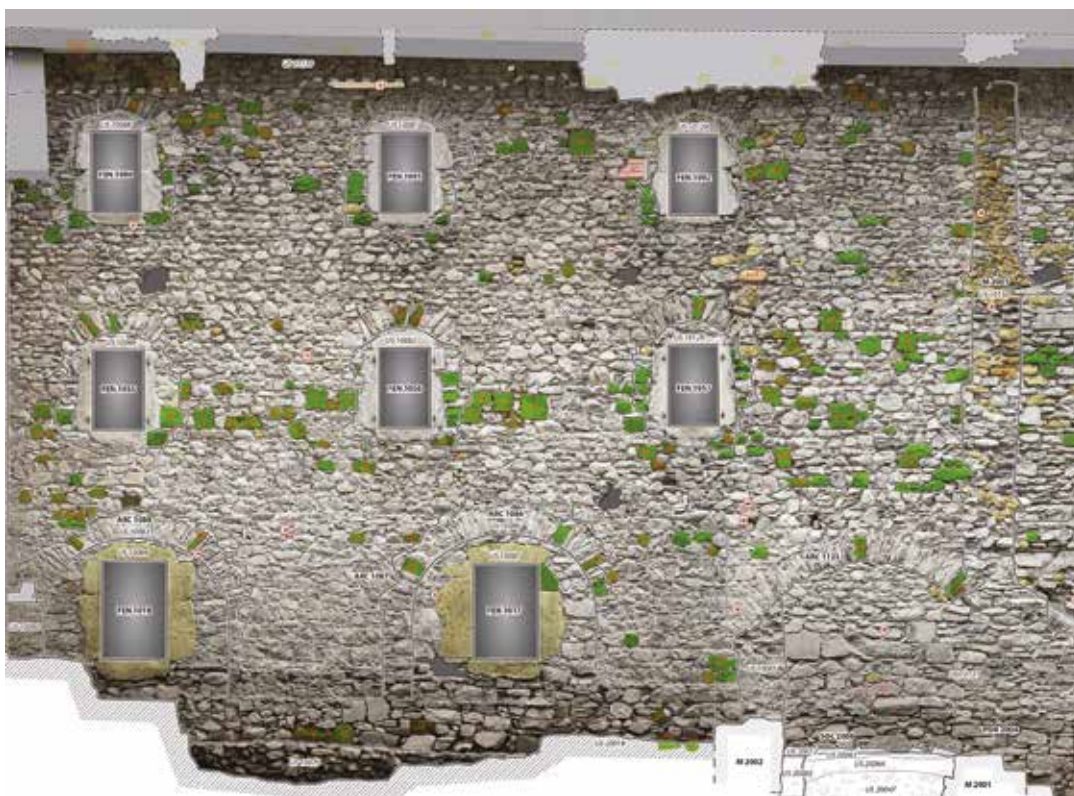
Fig. 2 : Extrait d'élévation du mur nord du bâtiment (M 1001) avec les remplis en grès (en vert).
