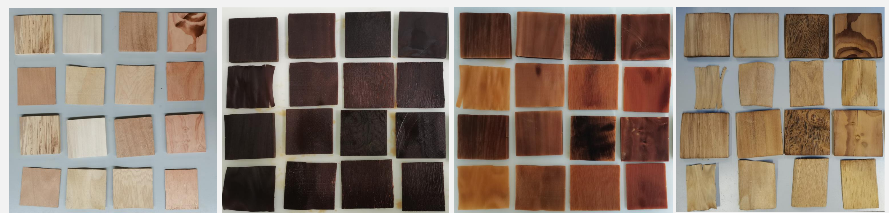
Fig. 3: Variation de couleur et de dimension des bois aux différents stades de délignification. 1 ère colonne à 4 ème colonne: Hêtre, Peuplier, Chêne, Douglas. 1 ère et 3 ème ligne: bois massif d'1 cm d'épaisseur. 2 ème et 4 ème ligne: placages de bois.
