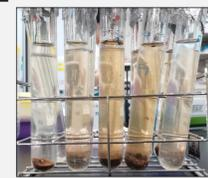
Fig. 3: Résidu insoluble obtenu après l'hydrolyse acide
