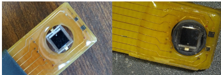
FIGURE 2 : À gauche, le capteur avec la photodiode et les LEDs éloignées, à droite celui avec les éléments proches.
