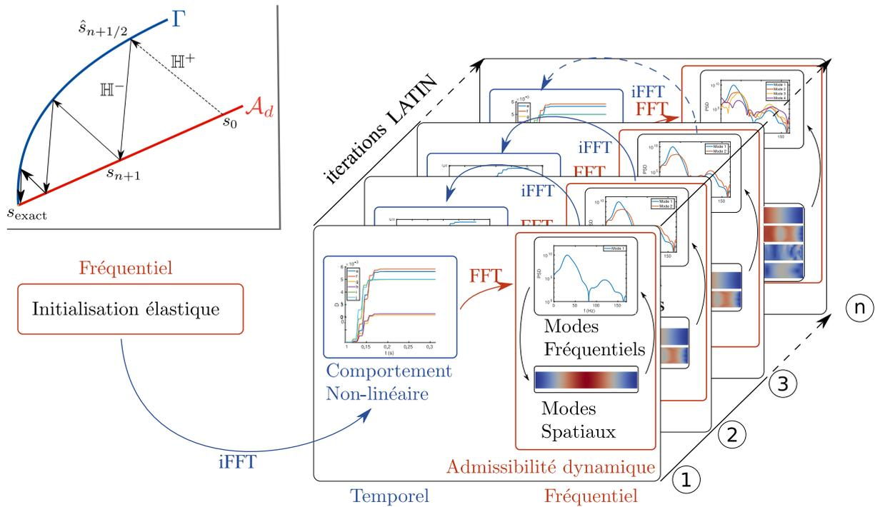
FIGURE 1 – Représentation graphique du solveur hybride temps-fréquence
