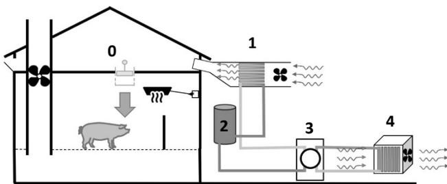
**Figure 1** – Dispositif expérimental du module de thermo-régulation de l'air ambiant (0 : porcherie avec un air ambiant à la température désirée / 1 et 2 : aérotherme relié à un ballon d'eau / 3 : pompe à chaleur / 4 : dissipateur ou capteur de calories (selon les essais))
