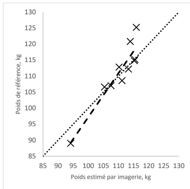
**Figure 1** – Comparaison entre le poids estimé par vision par ordinateur (image entière, vue du dessus) et la vérité terrain mesurée par une balance. Chaque point correspond à un porc de la base de données d'évaluation. La ligne pointillée épaisse est la courbe de tendance. La diagonale pointillée représente la correspondance parfaite.
