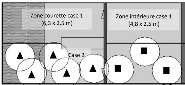
**Figure 1** - Vue aérienne de deux cases d'élevage et positionnement dans une case des huit antennes RFID UHF (cinq en courette (triangle) et trois en zone intérieure (carré))
