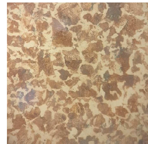
Acier au carbone ferrito-perlitique contenant plus de ferrite que de perlite (0,55%C) - dureté 160HV Rm = 550 MPa, Allongement à rupture = 18%
