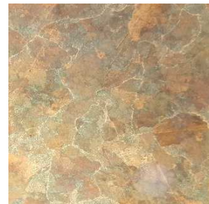
Acier au carbone hyper-eutectoïde contenant surtout de la perlite mais aussi de la cémentite pro-eutectoïde (1,2%C) - dureté 220HV Rm = 750 MPa, Allongement à rupture = 10%
