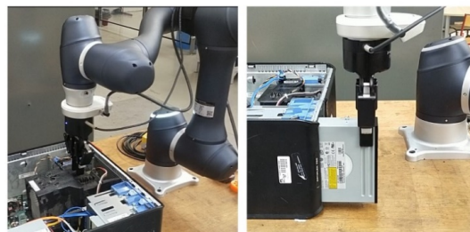
f. démontage robotisé
