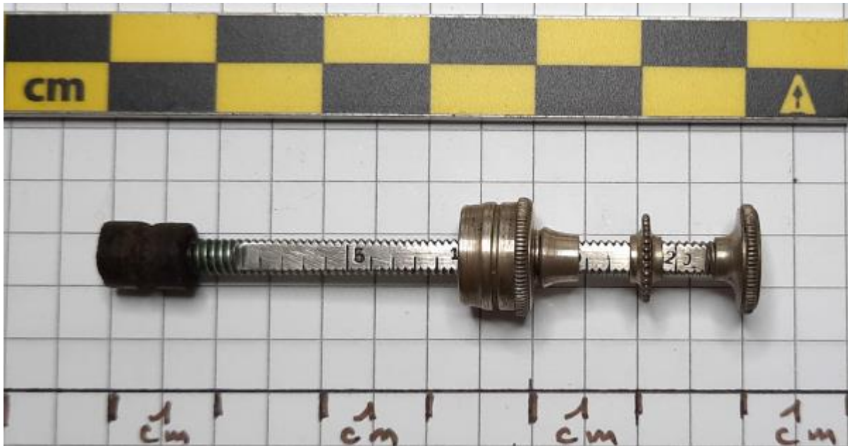
Figure 5 : Tige de piston de seringue de Pravaz modifiée : joint double parachute, tige aplatie et graduée, écrou curseur vissé sur la tige de piston, tête de tige de piston forme bouton. © Collection de l'auteur.
