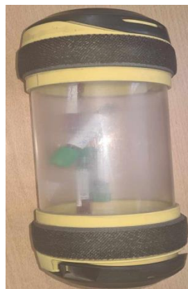
Figure 1 : Système de transport par pneumatique Figure 2 : Capsule de transport
