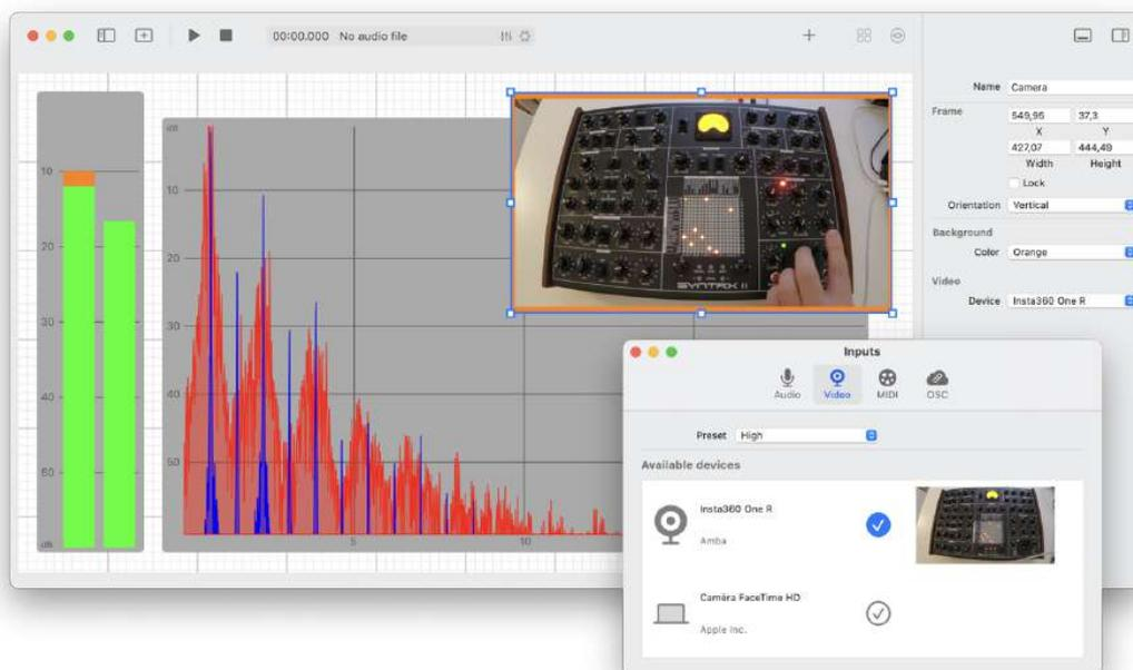
**Figure 7.** La capture de l'audio et de la vidéo dans l'interface d'un document Live de iAnalyse 6 : (gauche) affichage de type VU-mètre RMS, (centre) affichage de type spectre linéaire, (haut à droite) affichage d'une caméra connectée à l'ordinateur. En complément, en bas à droite apparaît l'interface vidéo de l'InputManager permettant de gérer la connexion des périphériques.
