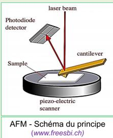
Utilisation de la pointe AFM pour user progressivement la surface du matériau sur une surface 1 μm<sup>2</sup> (F<sub>N</sub> ≥ 200nN, V<sub>T</sub> = 2 μm/s) + suivi topographique par imagerie de la profondeur z d'abrasion sur une surface de 5 μm<sup>2</sup> (F<sub>N</sub> = 100nN, V<sub>T</sub> = 10 μm/s)
