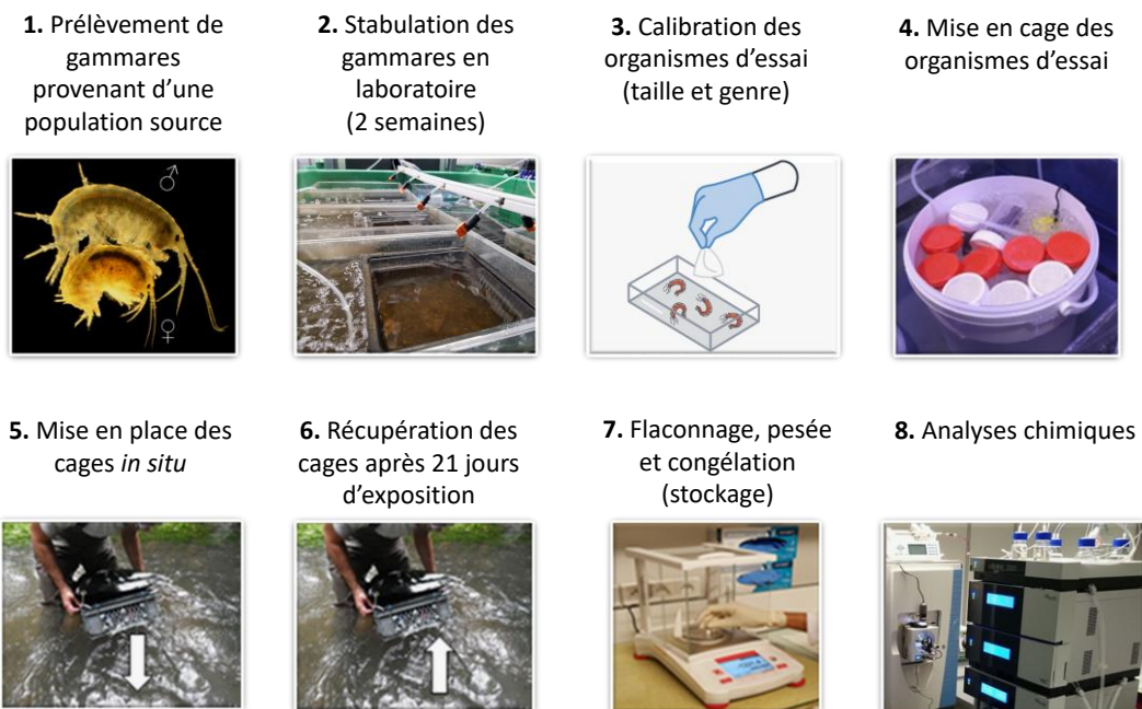
Figure 1 : Etapes de la méthode d'encagement in situ de gammarus pour la mesure de la bioaccumulation de substances chimiques
