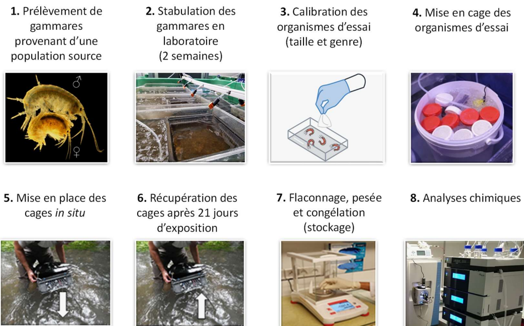
Figure 1 : Etapes de la méthode d'encagement in situ de gammares pour la mesure de la bioaccumulation de substances chimiques
