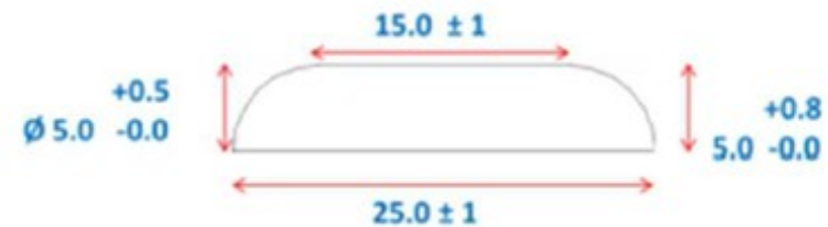
Figure 4 : Détail d'un plot
