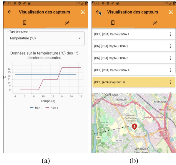
FIGURE 5 – HybridIoT pour Android : statistiques des valeurs de température sur les 15 dernières secondes fig. 5a), emplacement des capteurs et leur identifiant (fig. 5b).
