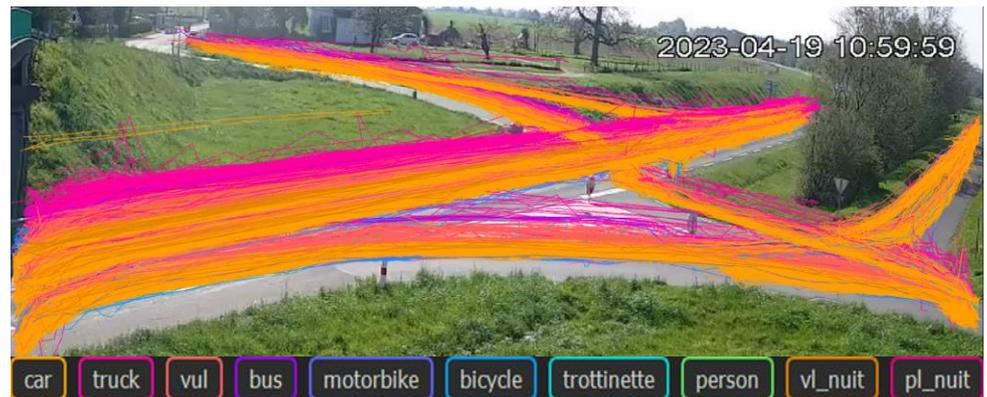
Source : extrait du logiciel de traitement vidéo par Intelligence Artificielle MinUI développé par la société ALYCE et utilisé l'intersection RD490/ RD65.
