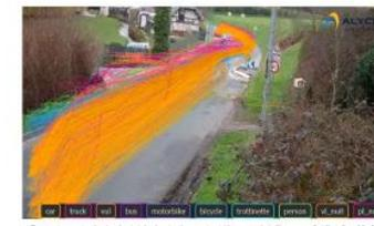
Source : extrait du logiciel de traitement vidéo par Intelligence Artificielle M&U développé par la société ALYCE et utilisé sur l'écluse côté Harfleur (deux sens de circulation).
