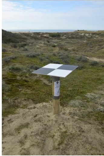
Figure 3. Cible fixe utilisée pour vérifier la qualité des produits générés.
