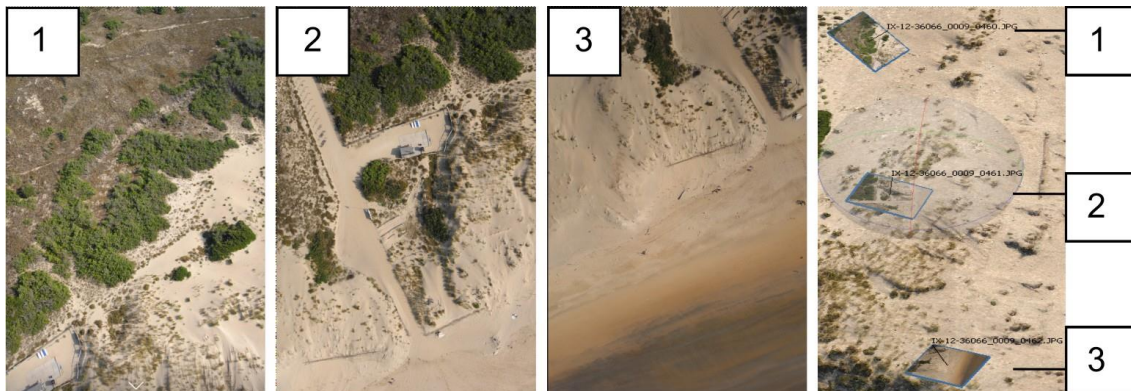
Figure 5. Exemple de 3 images prises consécutivement par la camera senseFly S.O.D.A. 3D à 3 angles différents lors de la mission 2. Pour les images 1, 2 et 3, les angles de la caméra sont respectivement de 29.52^\circ , 1.80^\circ et -28.35^\circ .
