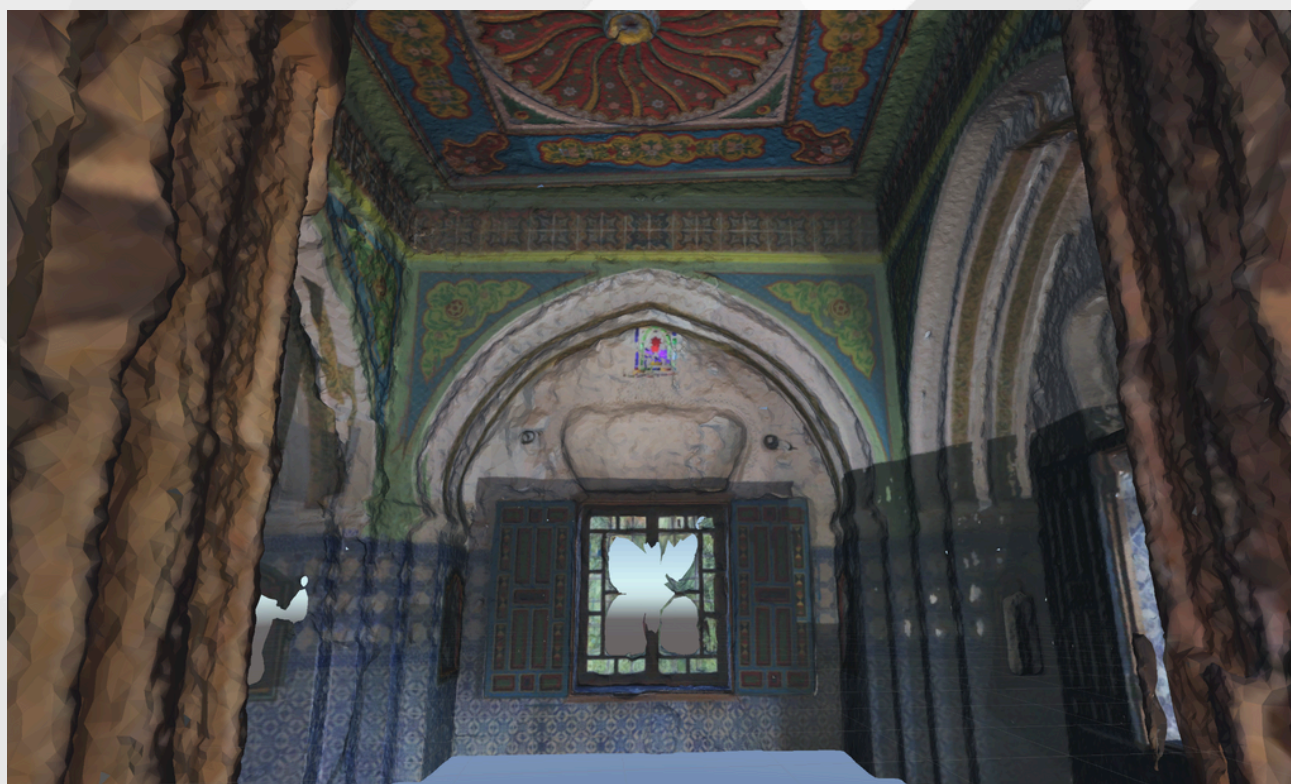
Figure 01 : Résultat du maillage lors de la construction du modèle 3D de la chambre de la favorite par photogrammétrie
