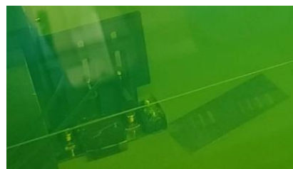
Déposition et fusion de 87 couches ( \approx 2,6\text{ mm} )
