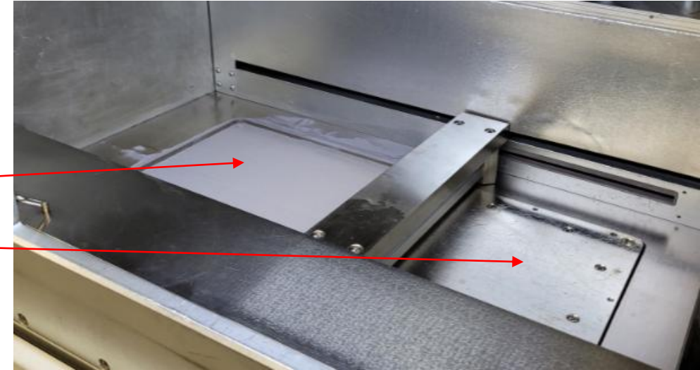
Chambre de fabrication
