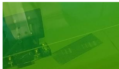
Déposition et fusion de 97 couches ( \approx 2,9\text{ mm} )
