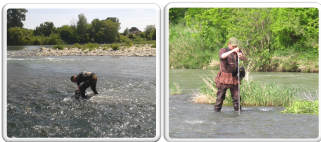
Photos 1-2 - Photo 1, à gauche, échantillonnage au cylindre de Hess (Montélimar, 24/04/2014). Photo 2, à droite, mesure de vitesse moyenne (Montélimar, 27/05/2012).
