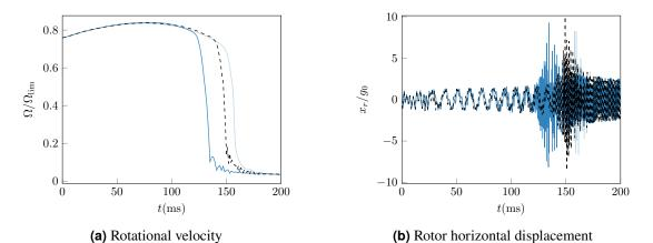
**Figure 13:** Mesh convergence analysis for  $\mu = 0.15$ :  $N_e = 36$  (---),  $N_e = 48$  (---),  $N_e = 60$  (---).
