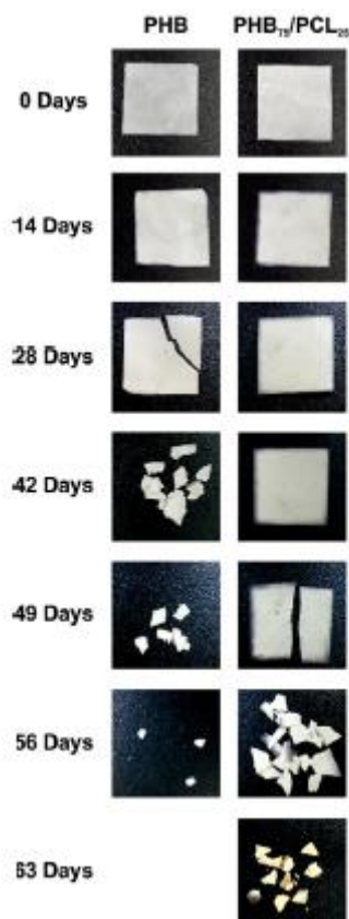
Figure 11 : Suivi et comparaison de la désintégration de films de PHB et mélange PHB/PCL 70
