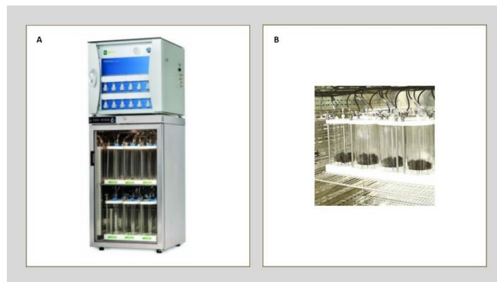
Figure 15 : Respiromètre ECHO A : enceinte + analyseur ; B : bioréacteurs
