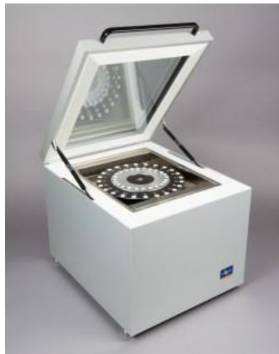
Figure 14 : Mesures de sorption de vapeur par DVS (Dynamic Vapor Sorption)
