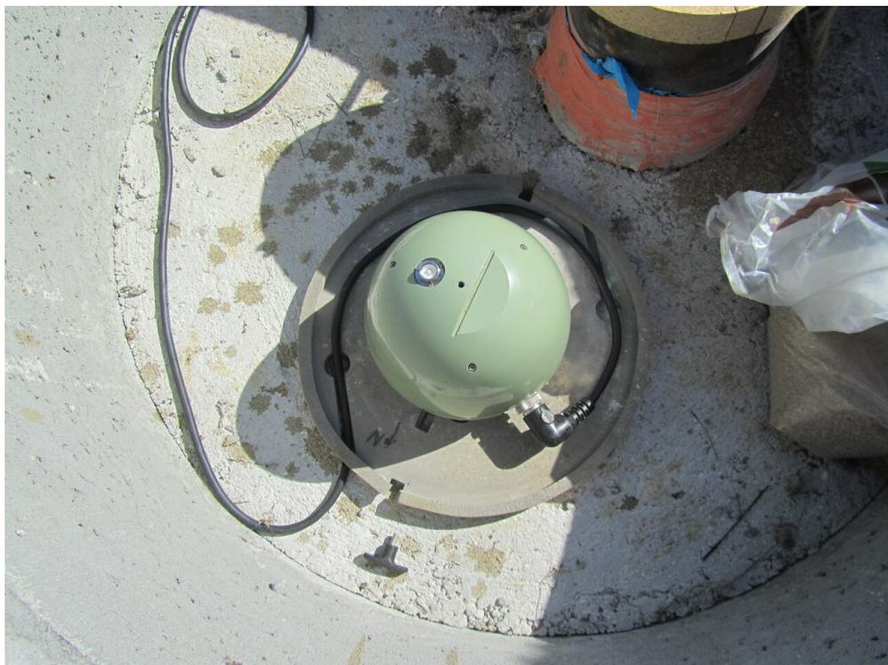
FIGURE 3.1 – Installation d'un sismomètre en surface (modèle T120QA) provenant de la station BOUF, situé à Bouguenais, France.
