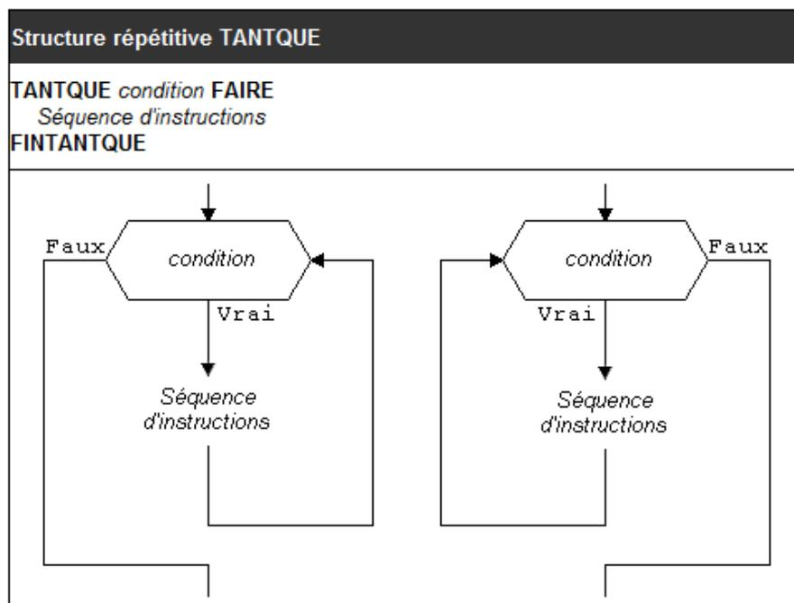
Dans la structure pseudo-code ci-dessus, le mot réservé **TANTQUE** indique le début de la structure répétitive, et le mot réservé **FINTANTQUE** en indique la fin. Dans la structure en organigramme, la condition indique le début de la structure répétitive et la fin de la branche étiquetée *Faux* en indique la fin.
