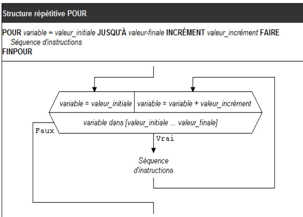
Dans la structure pseudo-code ci-dessus, le mot réservé **POUR** indique le début de la structure répétitive, et le mot réservé **FINPOUR** en indique la fin.
