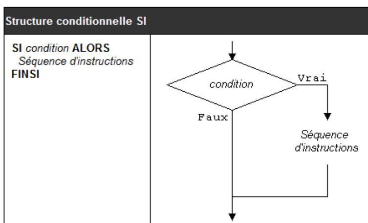
Dans la structure pseudo-code ci-dessus (à gauche), le mot réservé **SI** indique le début de la structure conditionnelle, et le mot réservé **FINSI** en indique la fin. Dans la structure en organigramme correspondante (à droite) la condition indique le début de la structure conditionnelle et la convergence des deux branches (branches *Vrai* et *Faux*) en indique la fin.
