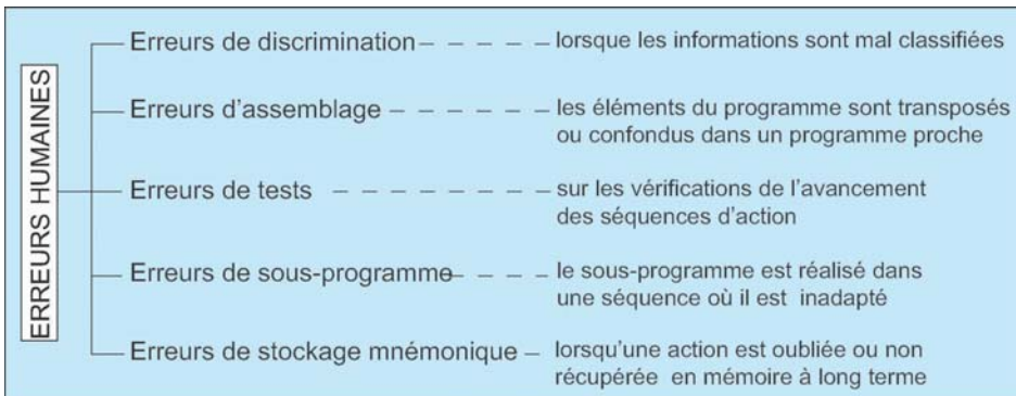
Figure 7 : Classification de l'erreur humaine basée sur la notion de plan d'action
