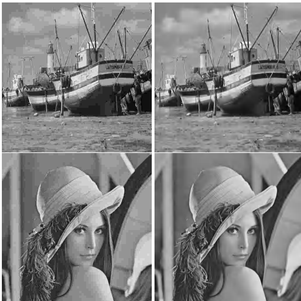
FIGURE 33 – Exemples de différence de qualité d’images restituées avec le même taux de compression de 0.2bpp soit en utilisant le standard JPEG à gauche, ou JPEG2000 à droite. On voit que pour des taux de compression assez grand, l’utilisation des ondelettes permet de tenir compte des redondances à toutes les échelles afin d’obtenir une meilleure restitution.
