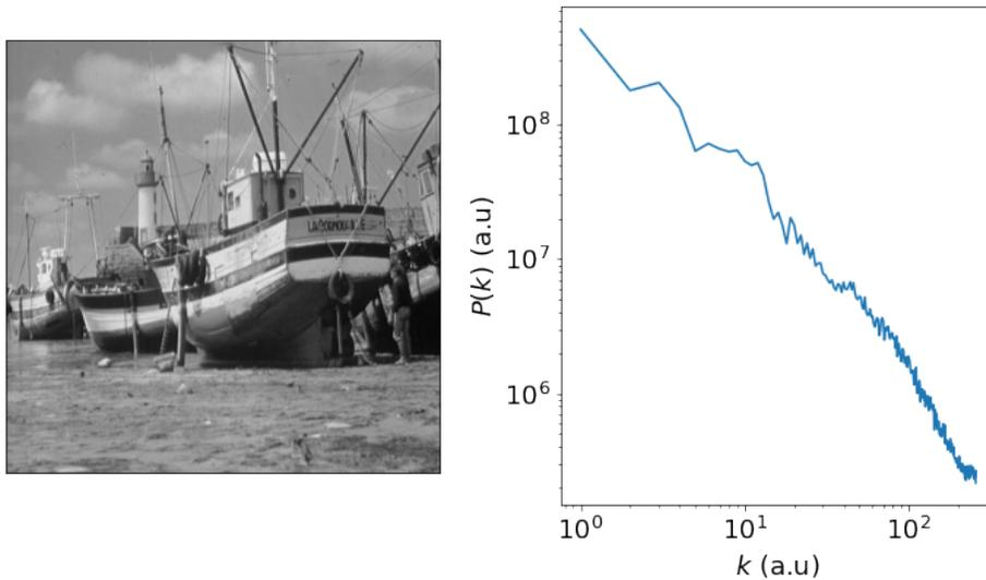
FIGURE 10 – Spectre de puissance d’une image classique, obtenu comme moyenne radiale de la norme au carré de la transformée de Fourier 2D de l’image. Ici  $k$  est le nombre d’onde en unité arbitraire. On observe bien une loi en  $1/k^2$  à grandes valeurs de  $k$  soit les petites échelles de l’image (à petits  $k$  on a plutôt ici une dépendance en  $1/k$ ).
