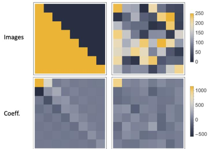
FIGURE 28 – Exemples de calcul des coefficients de décomposition d’images dans la base des 64 éléments de la figure 27. En haut: les images  $8 \times 8$  dont l’intensité est codée sur 8bits, avec à gauche une image de transition entre 2 régions uniformes et à droite une image random uniforme. En bas, le tableau des coefficients pour chaque image. Les échelles sont communes soit pour les images, soit pour les coefficients.
