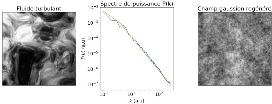
FIGURE 11 – A gauche une image d'un fluide turbulent dans une tuyau (Credit: Piotr Siedlecki/public domain); au centre le spectre de puissance issu de l'image ( $\propto k^{-2.2}$ ); à droite un champ gaussien généré à partir de ce spectre de puissance.
