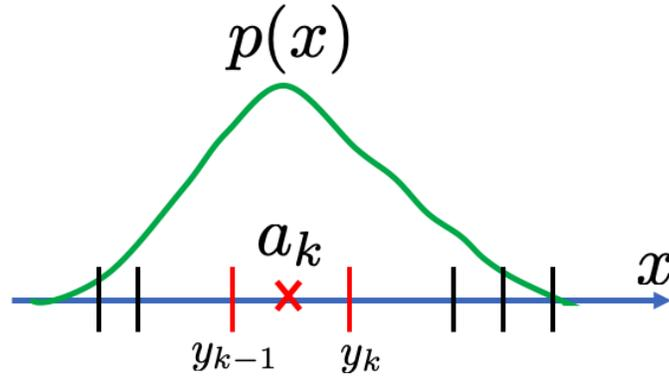
FIGURE 22 – Schématisation de l'opérateur de quantification (Eq. 239).
