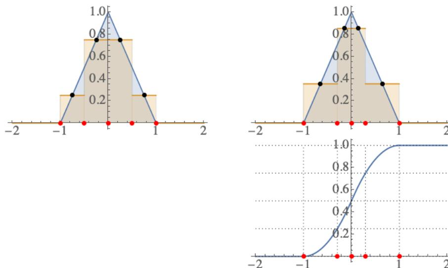
FIGURE 23 – Exemple de deux stratégies découpage de l'axe des  $x$  de densité de probabilité  $p(x)$  ici triangulaire sur  $[-1, 1]$ : à gauche, il s'agit du découpage uniforme ou quantification constante, à droite il s'agit du découpage effectué pour obtenir une probabilité constante dans chaque boîte. Ce dernier est obtenu en considérant la fonction de répartition  $F(x)$  (en bas à droite) et un découpage uniforme de l'axe des  $y$ .
