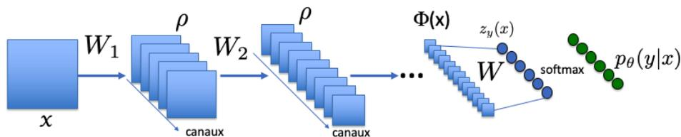
FIGURE 4 – Schématisation d'un réseau de neurones multi-couches (classification).
