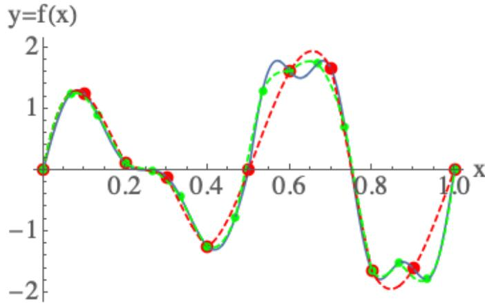
FIGURE 1 – Interpolations de deux jeux de données  $(x_i, y_i)$  (ici non bruitées; points rouges et verts) d’une fonction  $f$  sous-jacente inconnue (courbe bleue). Plus la population d’échantillons est dense meilleure est l’interpolation.
