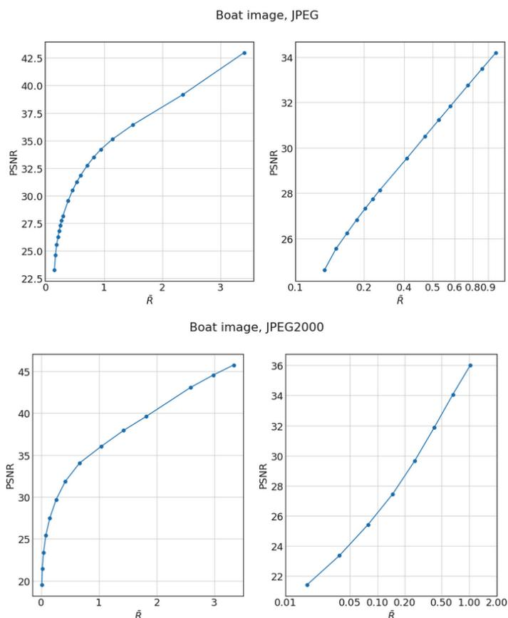
FIGURE 35 – Évolution du PSNR en fonction du nombre de bits par pixels pour l’image du bateau compressée au format JPEG (en haut) et JPEG2000 (en bas) . A droite, l’échelle de  $\bar{R}$  est en  $\log_2$ , alors qu’à gauche elle est linéaire.
