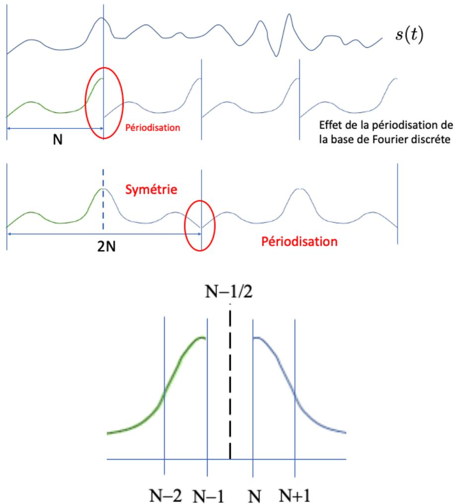
FIGURE 25 – En haut: Schématisation de la procédure de symétrisation pour palier l'effet de périodisation implicite d'une base de Fourier discrète. En périodisant directement le signal extrait, on introduit de grandes discontinuités de jointure. Après la symétrisation, il reste des discontinuités sur la dérivée mais beaucoup moins gênantes. En bas: en zoomant sur le point de jonction de la symétrisation, on s'aperçoit que la symétrie se fait autour d'un demi-entier.
