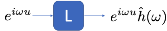
FIGURE 13 – L'opérateur linéaire covariant par translation noté L a pour vecteur propre les fonctions e^{i\omega u} dont les valeurs propres associées sont les valeurs de sa Fonction de Transfert estimée en \omega (cf. \hat{h}(\omega) ).
