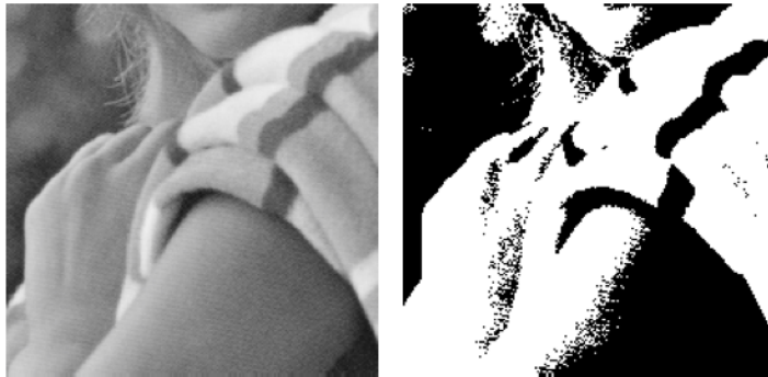
FIGURE 57 – A gauche image dont la valeur d'un pixel est codée sur 8bits (1byte) et à droite la même image où le codage se fait sur 1bit.
