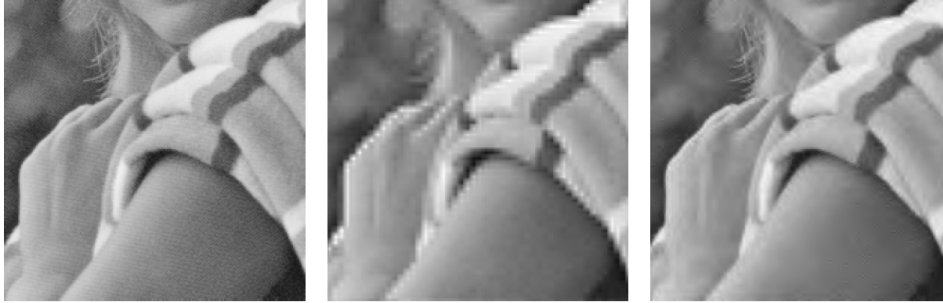
FIGURE 56 – Encart d’une image originale 512 \times 512 , au milieu une approximation linéaire qui réduit d’un facteur 16 la taille de l’image, et à droite une approximation non-linéaire également avec 1/16 des coefficients initiaux en partant d’une décomposition qui réduit d’un facteur 32 et complète avec des coefficients de détails.
