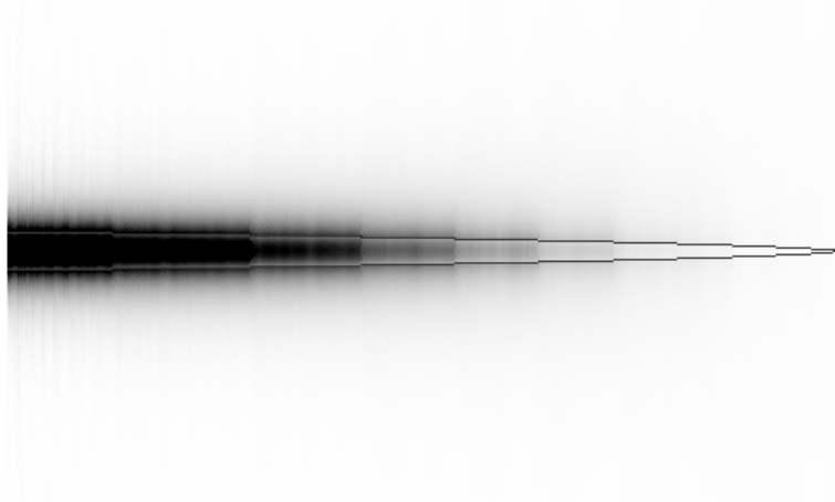
FIGURE 2.3 – Vue de dessus en BPM3D pour une longueur de 500 \mu\text{m} . L'échelle verticale est fortement dilatée afin que la forme du guide soit visible.
