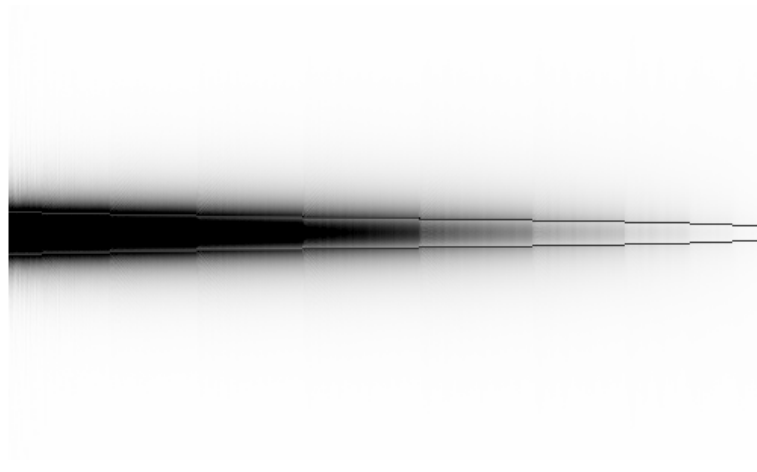
FIGURE 2.9 – Vue de dessus en BPM3D pour une longueur de 1 mm. L'échelle verticale est fortement dilatée afin que la forme du guide soit visible.
