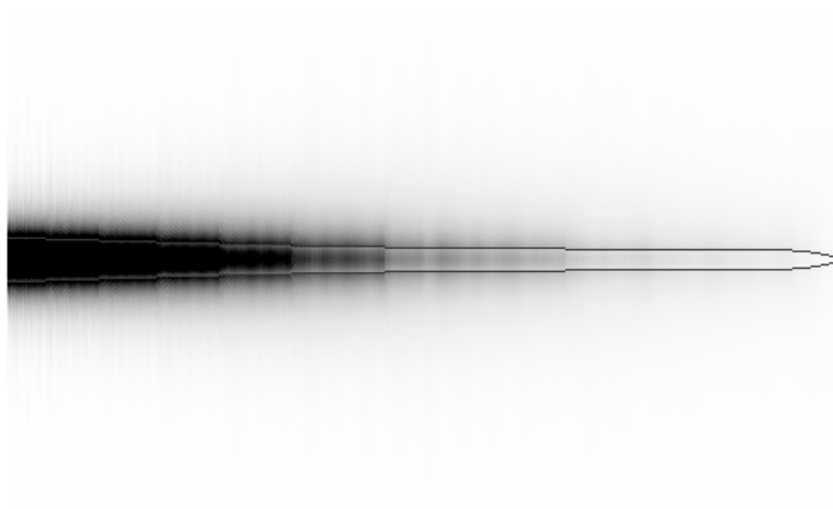
FIGURE 2.7 – Vue de dessus en BPM3D pour une longueur de 500 \mu\text{m} . L'échelle verticale est fortement dilatée afin que la forme du guide soit visible.
