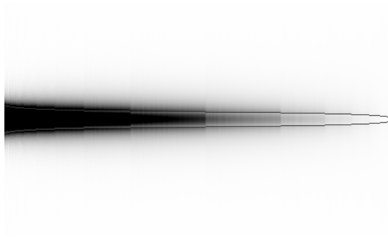
FIGURE 2.5 – Vue de dessus en BPM3D pour une longueur de 1 mm. L'échelle verticale est fortement dilatée afin que la forme du guide soit visible.
