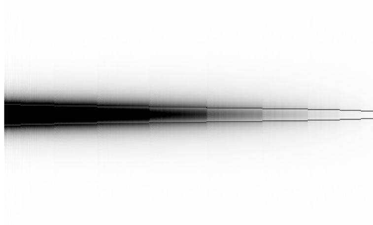
FIGURE 2.9 – Vue de dessus en BPM3D pour une longueur de 1 mm. L'échelle verticale est fortement dilatée afin que la forme du guide soit visible.
