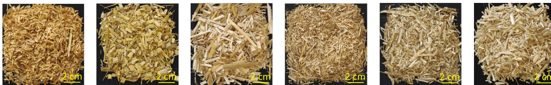
FIGURE 3. Photographies des granulats végétaux : balle de riz, bambou, miscanthus, roseau, colza, chènevotte
