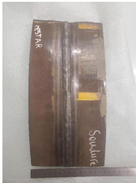
Figures 28, 29, 30, 31, 32 : Morceau de pipeline avec cordon de soudure.
