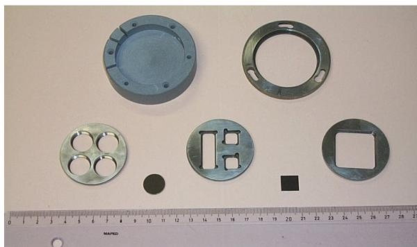
Figure 3 : céramique (stumatite) ,différents porte-échantillons, substrats (acier, silicium)
