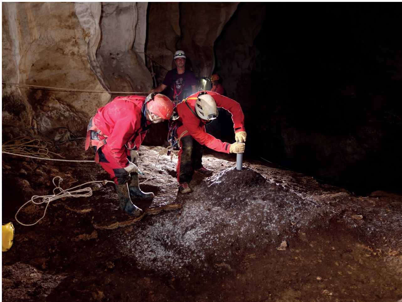
Fig. 5 – Carottage dans un tas de guano (grotte des Huguenots, Ardèche ; cliché J.-Y. Bigot).
