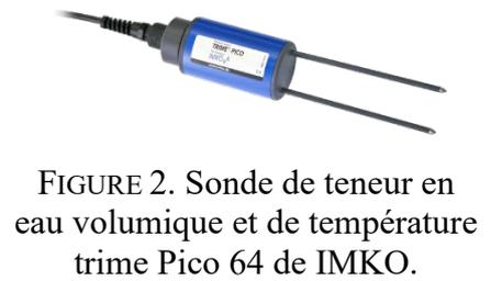
FIGURE 2. Sonde de teneur en eau volumique et de température trime Pico 64 de IMKO.
