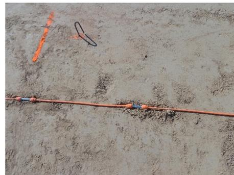
FIGURE 6. Électrode - boucle de connexion.
